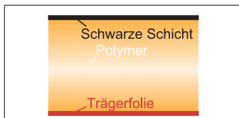
Abbildung 1: Aufbau einer Fotopolymerplatte.
